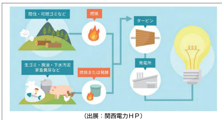
バイオマス発電は、バイオマスを燃料として「直接燃焼」した際の熱を利用したり、「ガス化」してタービンを回して電気を作る発電方式です。発電した際に発生する排熱は、暖房や温水として有効活用されています。
